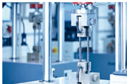
Dauerfestigkeits- und Zeitfestigkeitsüberprüfungen durch mehr als 15 Pulsatoren nach unterschiedlichen Prüfungsverfahren More than 15 pulsers are available for testing dynamic fatigue strength according to different testing methods
